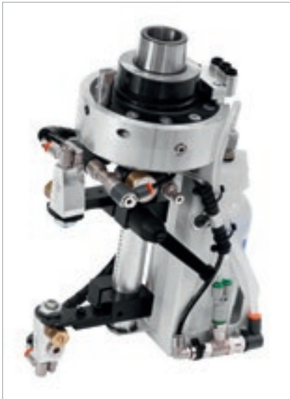
Agrégat souffleur et distributeur de liquide anti-adhésif.
