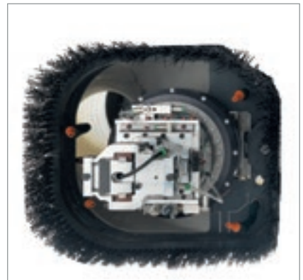
Groupe souffleur à 4 sorties utilisable également avec les agrégats de finition du chant.
