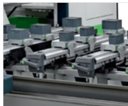
ATS (Advanced Table-Setting System) Permet un positionnement manuel simple et rapide des systèmes de blocage.
